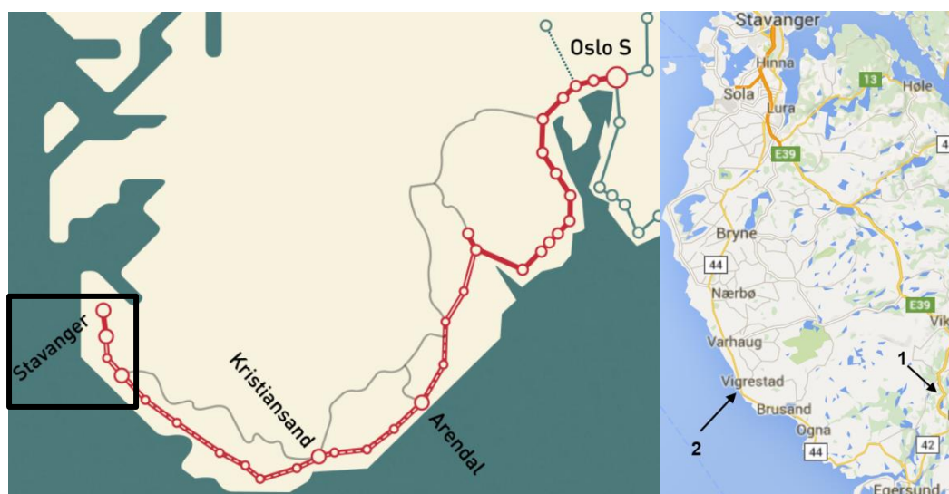
Figur 12: Til venstre: Overført trafikk mellom Egersund og Sandnes/Stavanger ved utbygging av dobbeltspor er merket med sort firkant. Til høyre: Trafikkregistreringspunkt for biltrafikk, ÅDT. 1: E39 Saglandsbakken, 2: Fv44 Kvassheim. Kart fra Google Maps.
